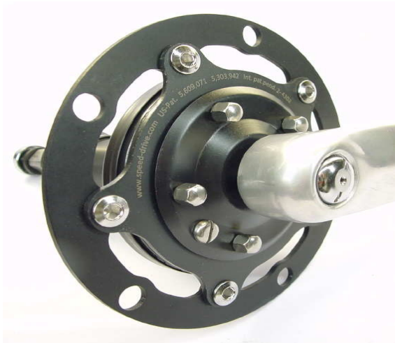
Speed-drive: Adapter von Lochkreisdurchmesser 110mm auf 130mm
