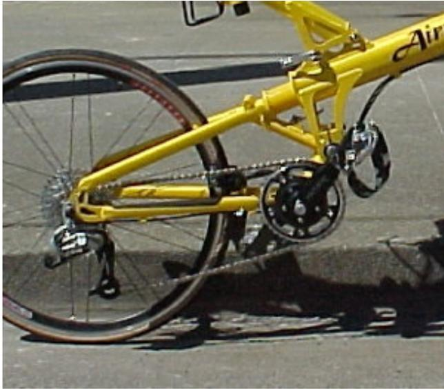
Durch das in der Regel massiv kleinere Kettenblatt des speed-drive - Getriebes ist ein allfälliger Schräglauf der Kette weniger gravierend, da die tangentialen Einlaufstrecke, auf der die Kette ins Kettenblatt "einläuft", sehr viel kürzer ist.
