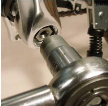
Als weiterer Arbeitgang ist noch die Kurbel festzuschrauben (mit einem Standard-14-er Steckschlüssel und einem Drehmoment von 50 - 55Nm) ...
