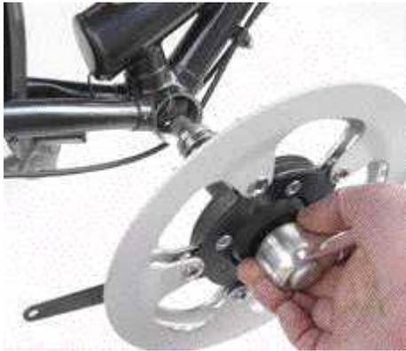
mountain-drive wird ins leere Tretlagerrohr eingeschoben und mit einer Nutmutter auf der linken Seite geklemmt. Das Getriebe ist für die meistverbreiteten Standard-Tretlager mit Innendurchmesser 33.6 - 34mm ausgelegt (BSA, M35x1).
