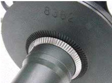
Für Stahltretlager wird rechts ein Alu-Konusring, für Alu-Tretlager ein verzahnter Stahl-Konusring verwendet.
