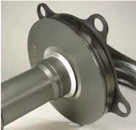
Beidseits eingelegte konische Ringe zentrieren das Getriebe perfekt im Tretlagerrohr und sichern es gegen Verdrehen.
