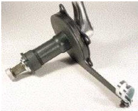
Die Drehmomentstütze wird mit einer Schelle/Bride an der Kettenstrebe befestigt und verhindert das Verdrehen unter Last. Diese Einbauart benötigt keinerlei Modifikation des Tretlagerrohres und keinen Fräser für den Einbau.
