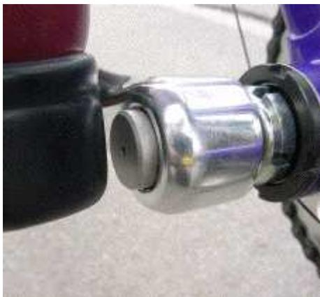
**Mountain-drive** wird durch einen leichten Druck der Ferse auf den links oder rechts bei der Tretkurbel leicht vorstehenden Knopf betätigt.
